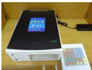
音声読書器 合成音声で墨字・点字書籍を読み上げる機器です。
